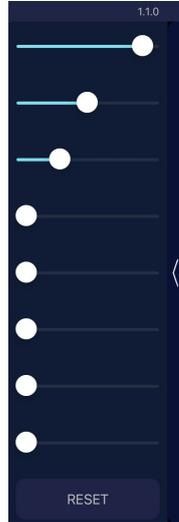
Finalmente, presionando sobre la barra vertical en el lateral derecho podemos desplegar los 8 tramos de **TGC** para ajustar la ganancia deseada correspondiente en cada zona.
