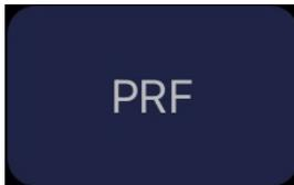
El PRF o Frecuencia de Repetición de Pulsos es un parámetro que ajusta el operador que define la tasa o frecuencia a la que el transductor va a emitir pulsos de ultrasonido para muestrear. Está relacionada con la velocidad del flujo a estudiar, de manera que si ésta es alta, requiere una alta tasa de muestreo para obtener datos fiables y por tanto el PRF ha de ser alto.
